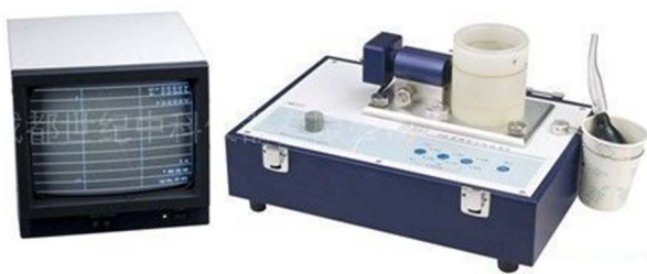
图 1 密立根油滴实验仪
